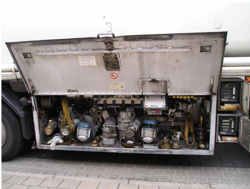
Bild 1: Messanlage eines Straßentankwagens
