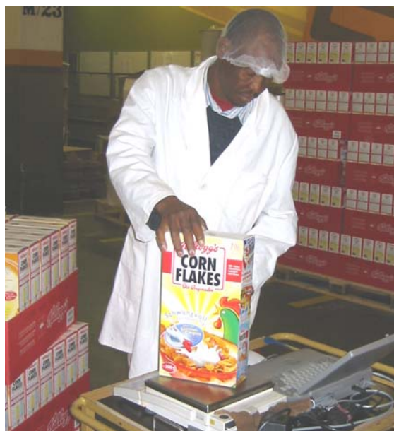
Bild 1: Rechnergestützte Füllmengenkontrolle mittels Kontrollwaage
