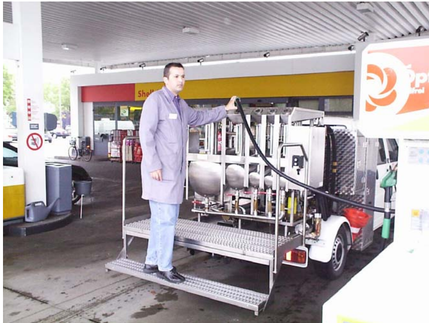
Herr Wohltmann bei der messtechnischen Prüfung einer Zapfsäule mit Hilfe des neuen Prüffahrzeugs
