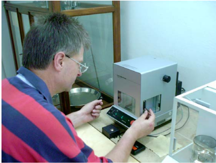
Herr Lindthammer bei der Kalibrierung eines Gewichtstückes mit einer Komparatorwaage.
