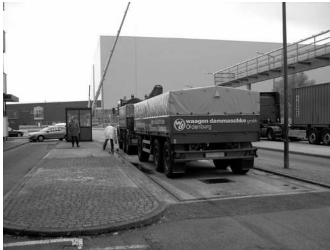
Belastungsfahrzeug auf der Waagenbrücke einer Fahrzeugwaage
