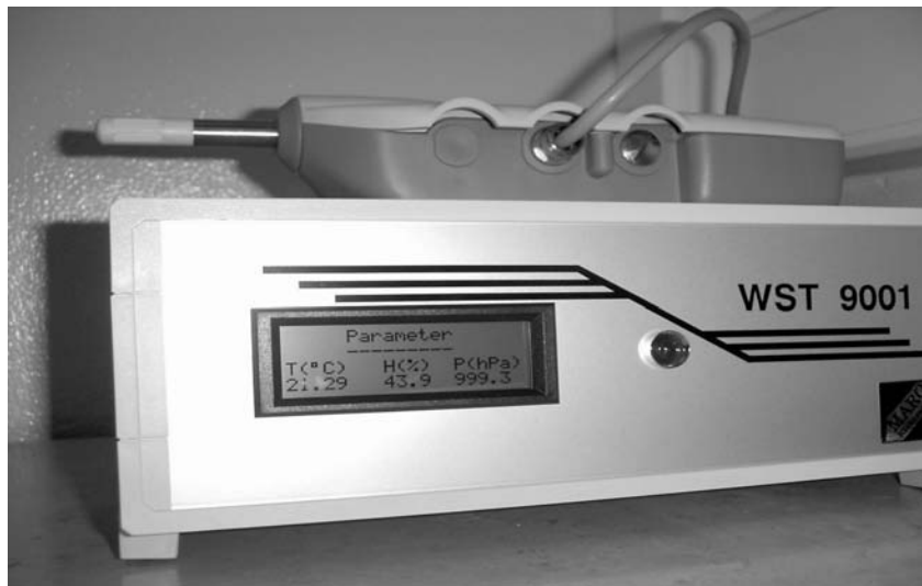
Wetterstation im Messraum des Eichamtes Bremen
